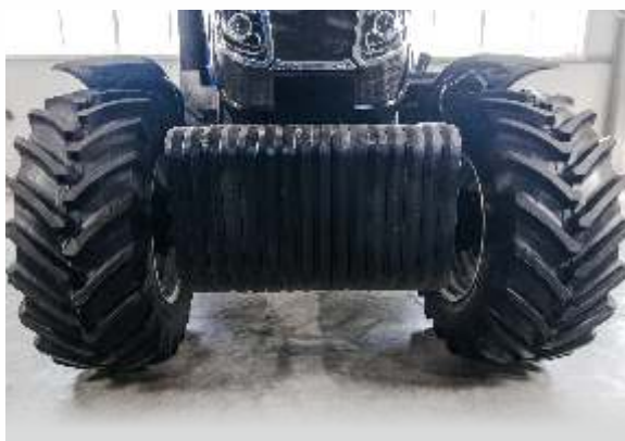
Широкие колёса 540/65R30; 650/65R42 (передние; задние) - максимальное сцепление с поверхностью
