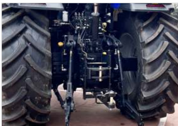
III категория навески ЗНУ с гидравлической тягой и электронным управлением
