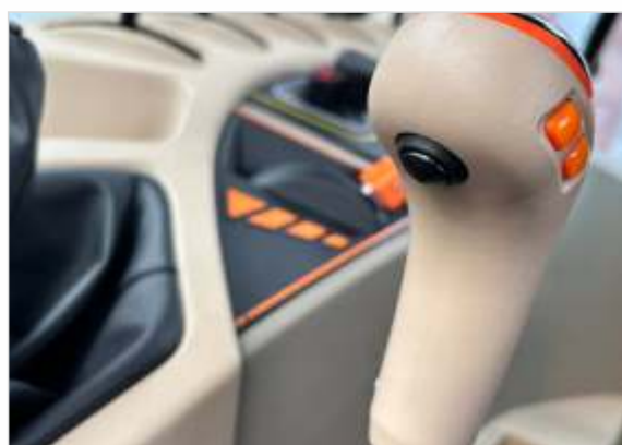
КПП технологии POWER REVERSING. Включение power high и low gear без разрыва потока мощности для повышения эффективности работы
