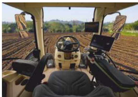
Амортизирующая четырехстоечная кабина с обзором 360°
