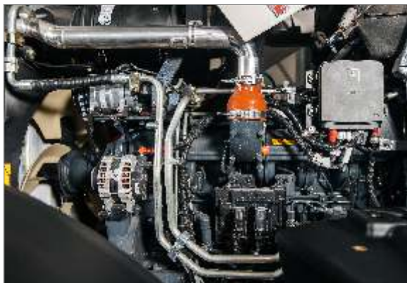
Дизельный двигатель 6-цилиндровый Weichai WP7G260
