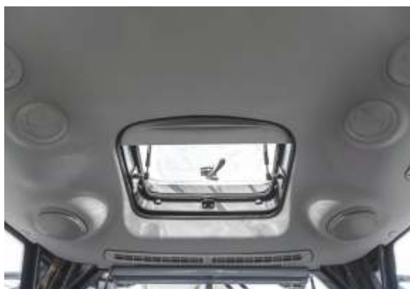
Трактора оборудованы люком и солнцезащитной шторкой
