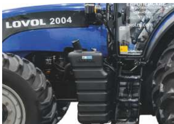
Топливный бак большой емкости на 350 л.
