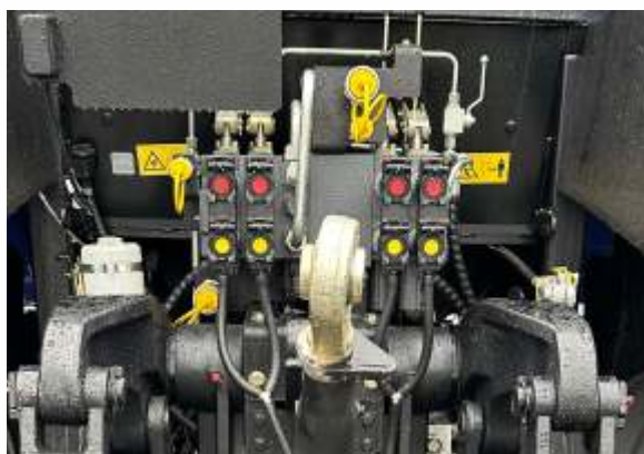
Четырех секционный гидравлический распределитель
