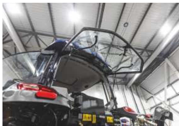
Заднее стекло кабины оснащено пневматическими амортизаторами
