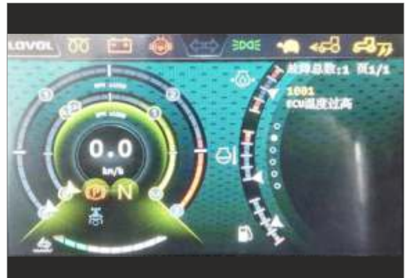
Многофункциональный ЖК-дисплей с функцией автодиагностики системы
