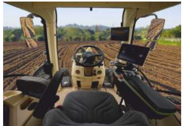
Амортизирующая четырехстоечная кабина с обзором 360°
