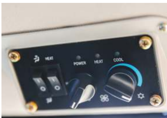
Трактор оснащен блоком контроля климата
