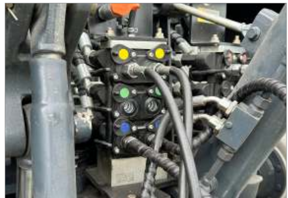
6 пар механических клапанов + 1 силовая пара (POWER BEYOND)
