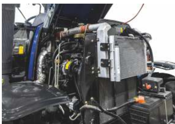
Интеркулер для охлаждения нагнетаемого воздуха
