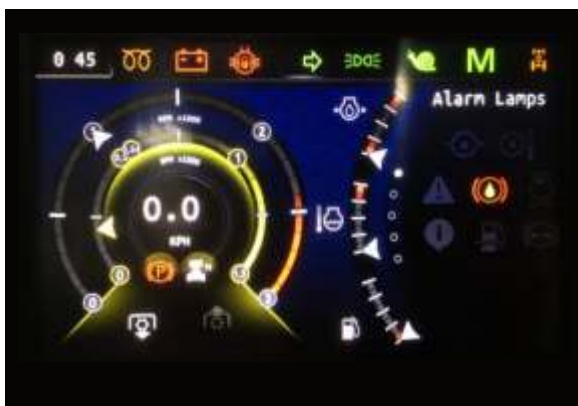
Многофункциональный ЖК-дисплей с функцией автодиагностики системы, может отображать код неисправности
